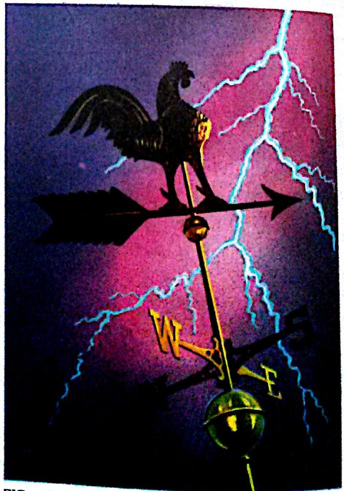
FIG. 137. La veleta es el instrumento más sencillo para conocer la dirección en la cual sopla el viento.
